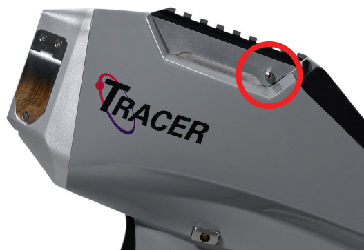
ヘリウムパージ用ポート接続部(赤丸部分)
